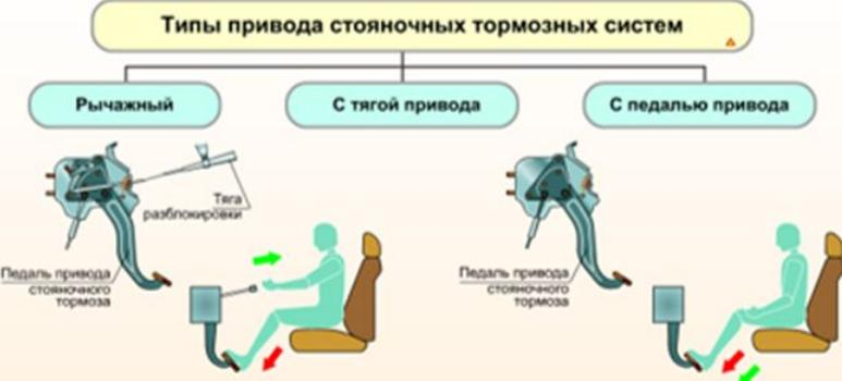
Стояночные тормозные системы с педалью привода используют в ряде моделей легковых автомобилей высокого класса. Разблокировка стояночного тормоза в большинстве случаев производится также при помощи педали
