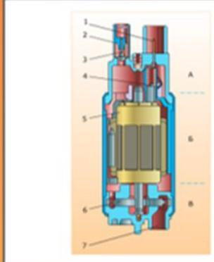
Топливонасасывающий насос подает к двигателю бензин под давлением от 0,3 до 0,45 МПа, в зависимости от особенностей конкретной системы впрыска. Насос расположен в топливном баке и конструктивно состоит из следующих узлов:
