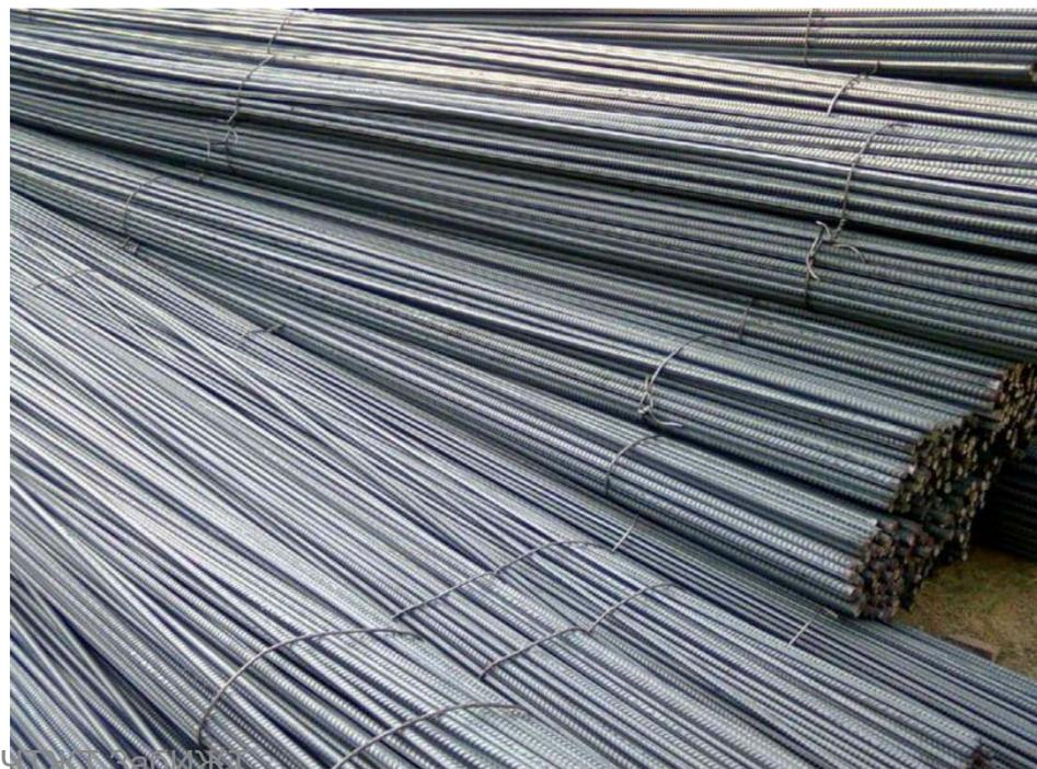
С повышением класса повышается предел прочности. Арматурные стержни класса АІ гладкие, АІІ – АVІ периодического профиля для улучшения сцепления с бетоном.
