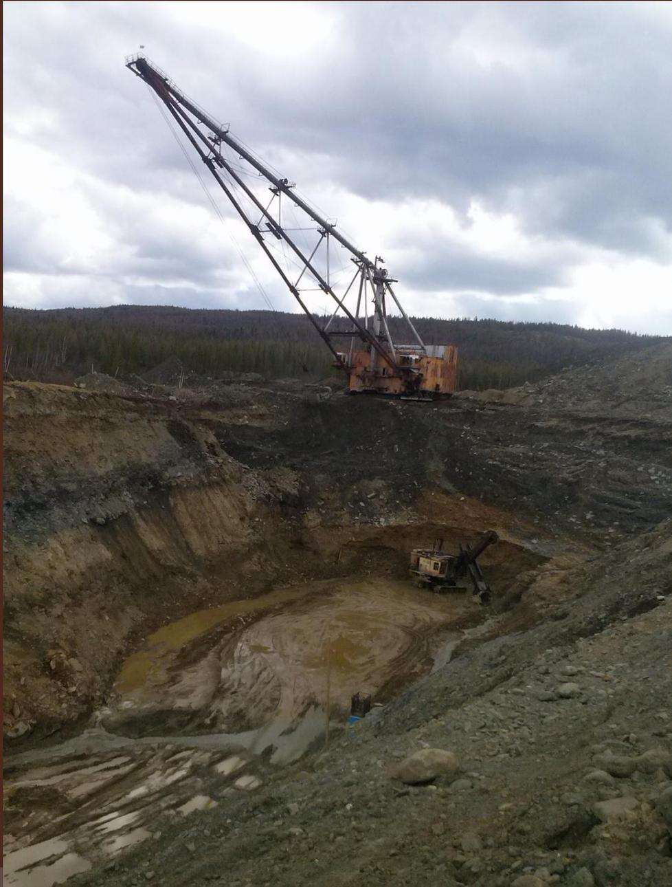
Открытую горную выработку, имеющую значительную длину по сравнению с шириной и глубиной, называют **траншеей**. Траншея имеет трапециевидное поперечное сечение. Ограничивается она с боков **бортами**, а снизу — **почвой**.
