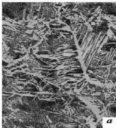
а - видманштеттова структура литой доэвтектоидной стали
