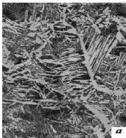
а - видманштеттова структура литой доэвтектоидной стали
