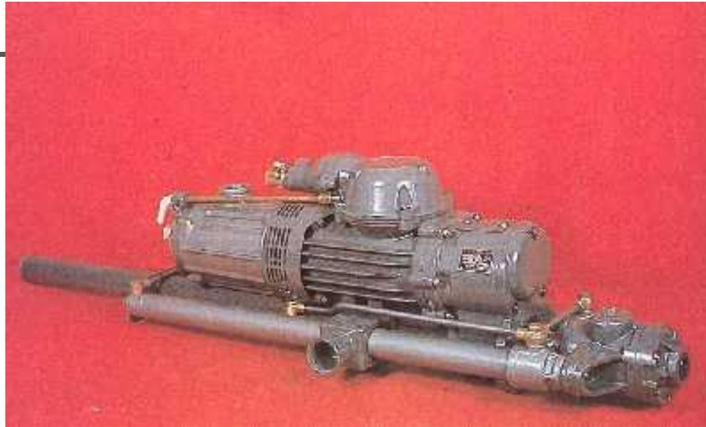
Бур электрогидравлический ЭБГП-1М предназначен для бурения шпуров с промывкой диаметром до 50 мм в породах с коэффициентом крепости до 9 по шкале М.М. Протодряконова
