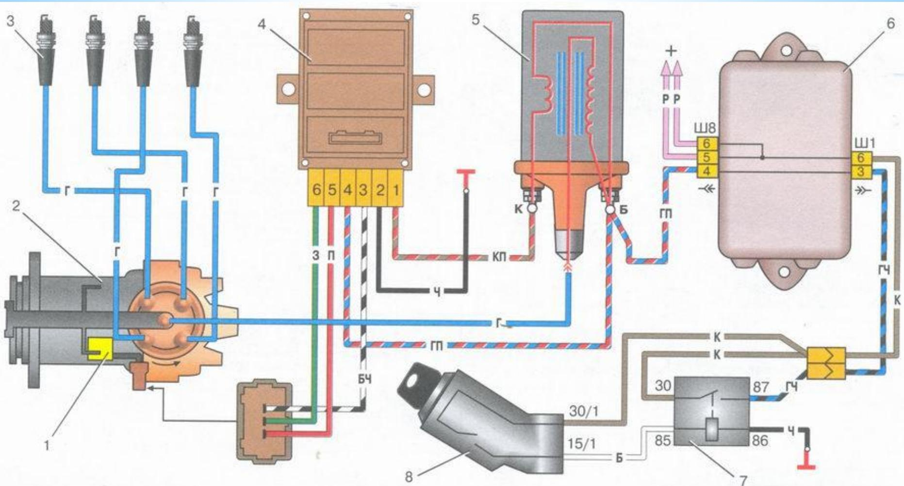
**Схема бесконтактной системы зажигания автомобиля ваз 2108, ваз 2109, ваз 21099:**
