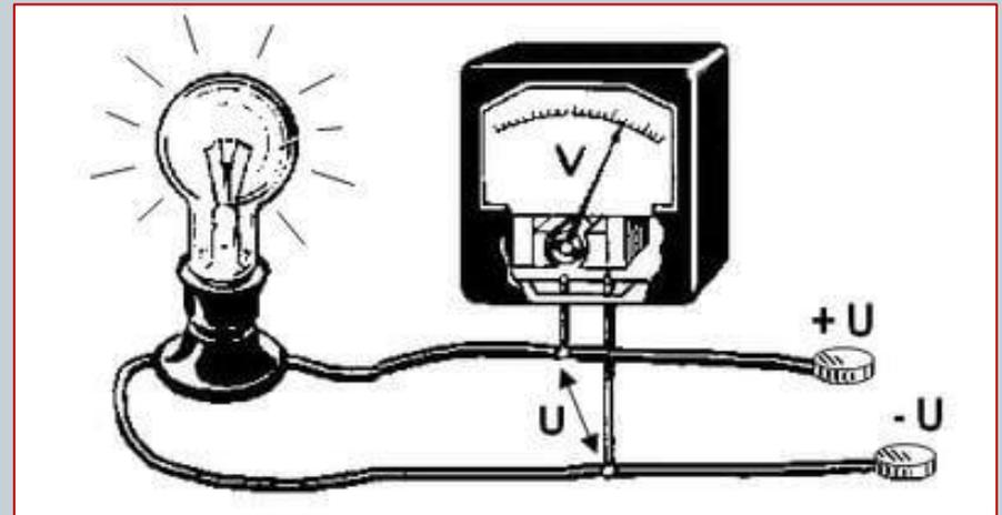
Сопротивление вольтметра должно быть максимальным, чтобы прибор не влиял на схему.
