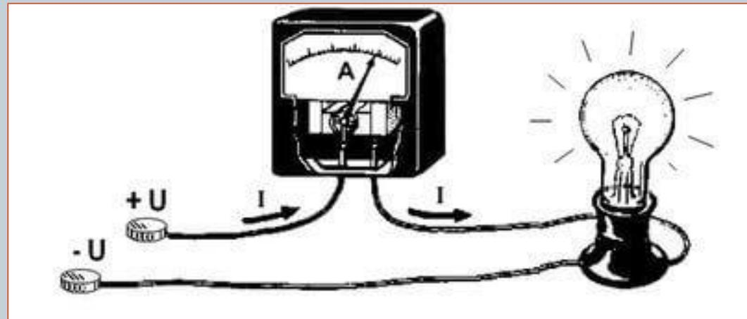
Сопротивление амперметра должно быть минимальным, чтобы прибор не влиял на схему.
