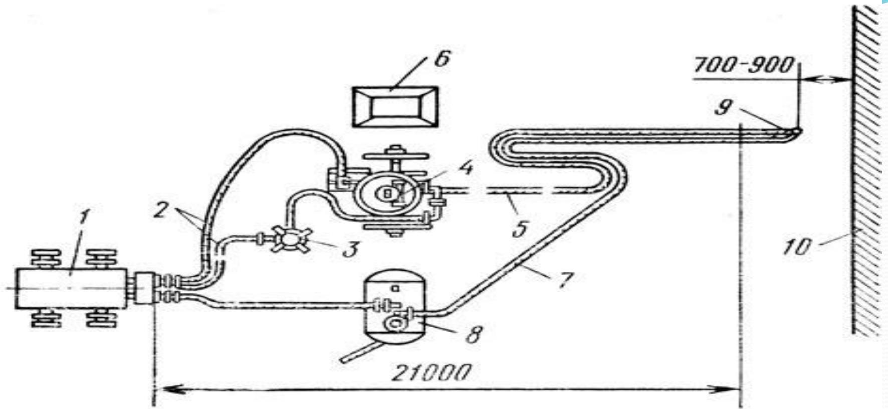
1 - компрессор, 2 - шланги для подачи воздуха, 3 - воздухоочиститель, 4 - цемент-пушка, 5 - шланг для подачи сухой смеси, 6 - емкость для сухой смеси, 7 - шланг для воды, 8 - расходный бак для воды, 9 - сопло, 10 - оштукатуриваемая поверхность
