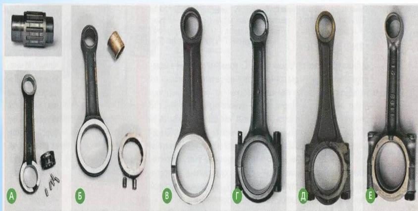
Шатуны с виду разные, но суть их одна (слева направо): А – 2-тактника «полтинника»; Б – неразъемный шатун «Урала» – конструкция, вымирающая из-за ненадежности смазки нижней головки; В – овалный шатун «Урала» жесткостью не блещет, а если оценивать с позиции применения его при твининге (облегчении) – никуда не годен; Г – шатун с разъемной кривошипной головкой (в двигателе «Днепра»); Д и Е – шатуны импортных мотоциклов www.relativ.org.ru
