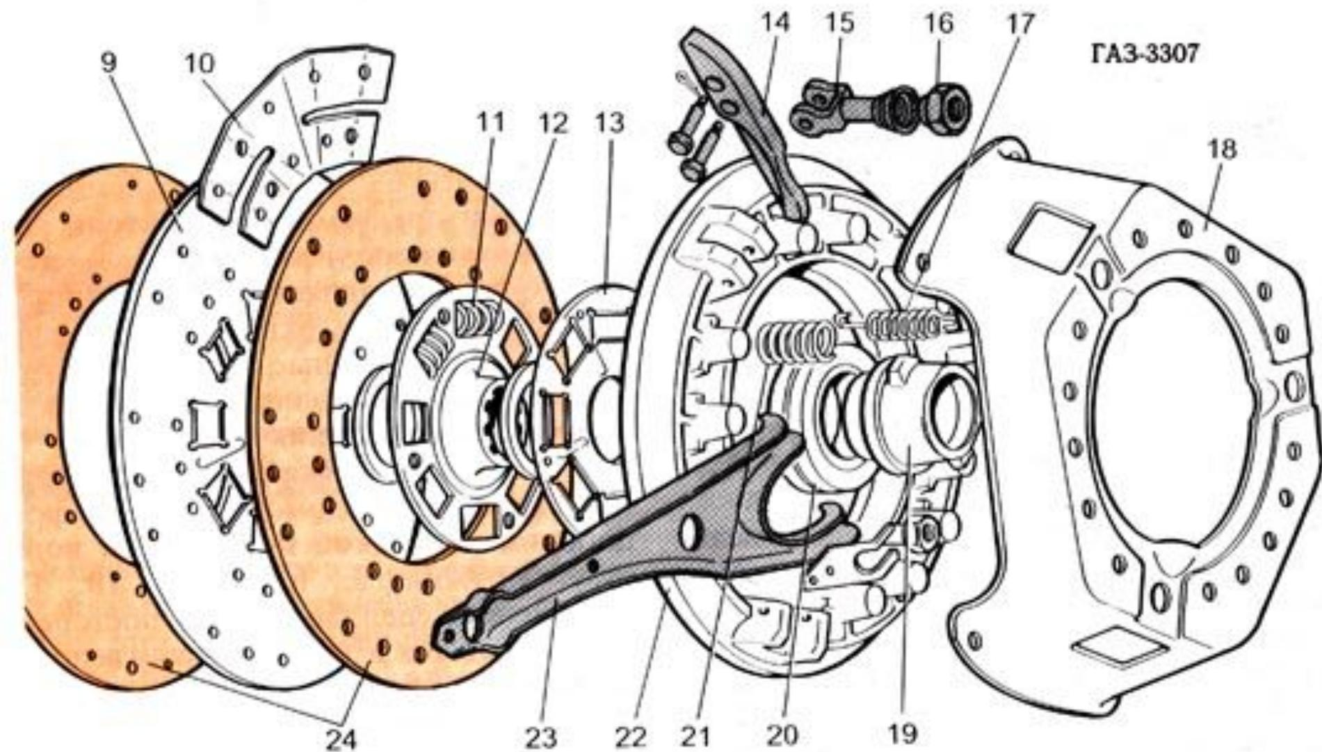
1 -ведущий диск, 2 –пружина, 9 –ведомый диск, 14 –отжимные рычаги, 20 –выжимной подшипник, 7 –педаль, 10 –пружинная пластина, 11 –пружина демпфера, 12 –ступица ведомого диска, 13 –пластина демпфера, 15 –вилка отжимного рычага, 16 –регулировочная гайка, 17 –оттяжная пружина, 18 –кожух, 21 –нажимная пружина, 22 –нажимной диск, 23 –вилка выключения сцепления, 24 –фрикционные накладки ведомого диска.
