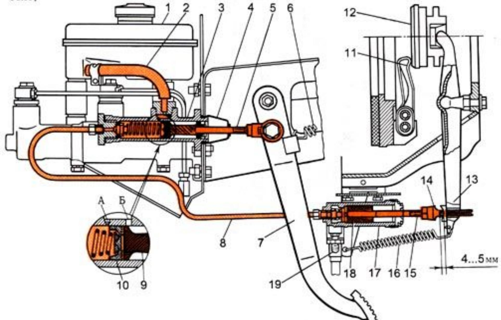
Механический привод сцепления
