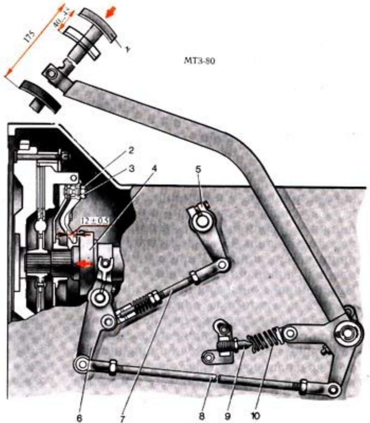
Пневматический усилитель выключения сцепления
