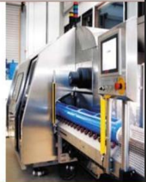
Рис. 1. График давление-температура для инактивации за пять лог-циклов отдельных штаммов микроорганизмов (слева). Оборудование высокого давления 600 МПа, объем 55 л (справа)
