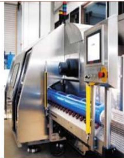
Рис. 1. График давление-температура для инактивации за пять лог-циклов отдельных штаммов микроорганизмов (слева). Оборудование высокого давления 600 МПа, объем 55 л (справа)
