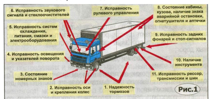
Запрещается движение при неисправности рабочей тормозной системы, ...
