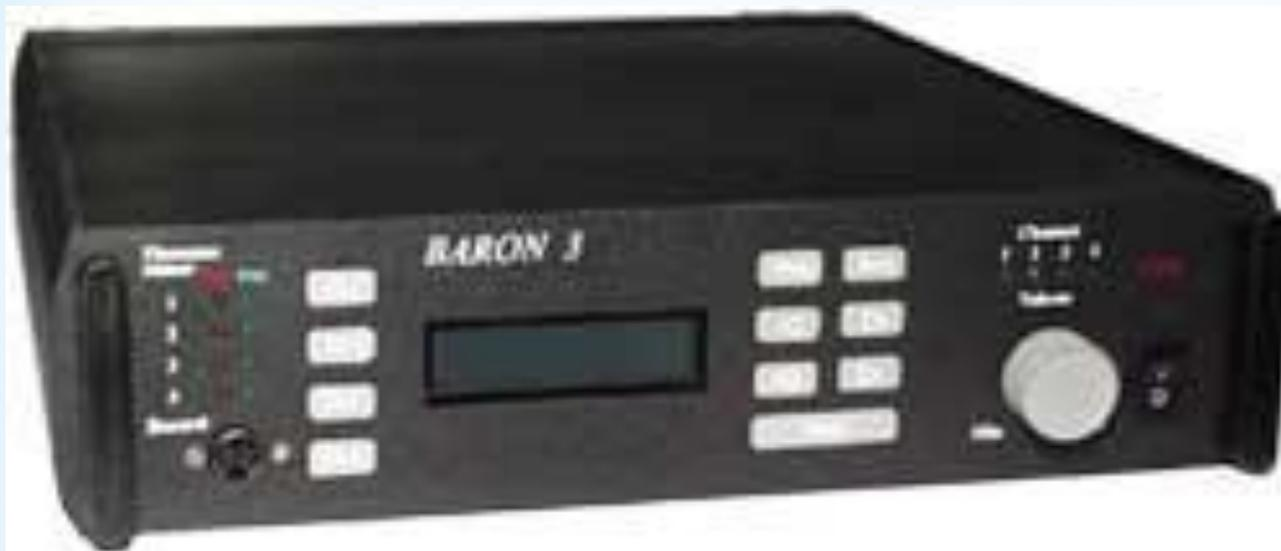
Имеет четыре канала формирования помех, к каждому из которых могут подключаться вибропреобразователи пьезоэлектрического или электромагнитного типа, а также акустические системы, обеспечивающие преобразование электрического сигнала, формируемого прибором, в механические колебания в ограждающих конструкциях защищаемого помещения, а также в акустические колебания воздуха.
