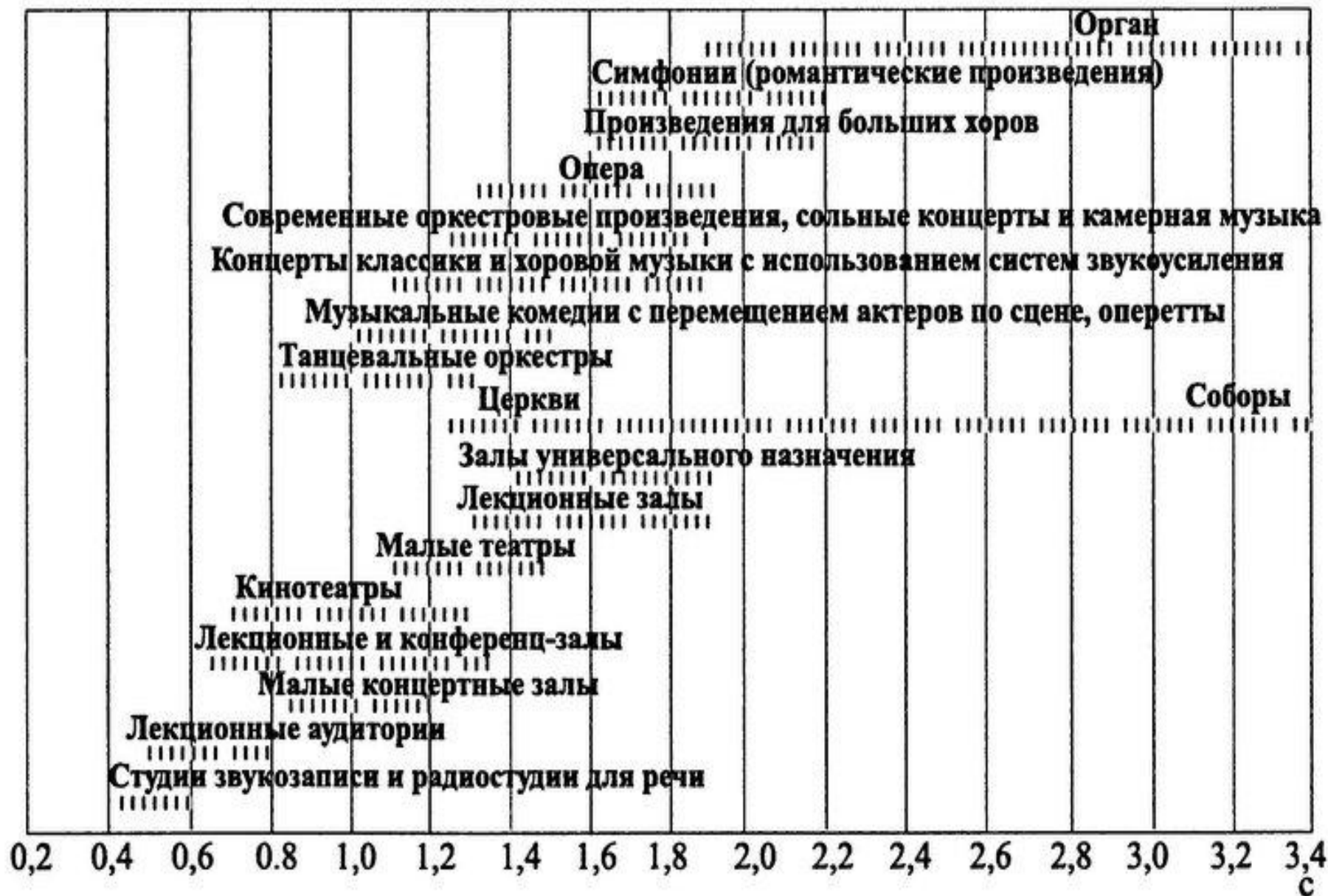
Рис. 5.1.15. Оптимальное время реверберации на частотах 500–1000 Гц
