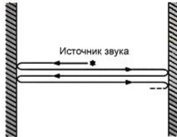
Порхающее эхо, возникшее после размещения источника звука между параллельными, гладкими поверхностями с высокой отражающей способностью
