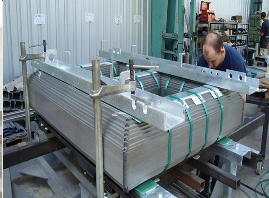
Step-lap технологиясы бойынша магниттік жүйені құрастыру
