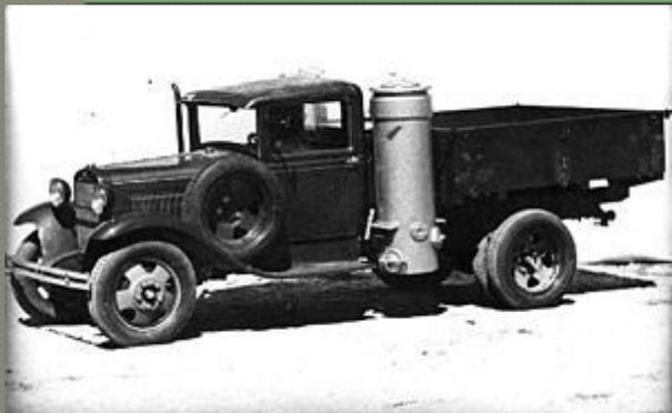
Автомобиль с газогенератором
