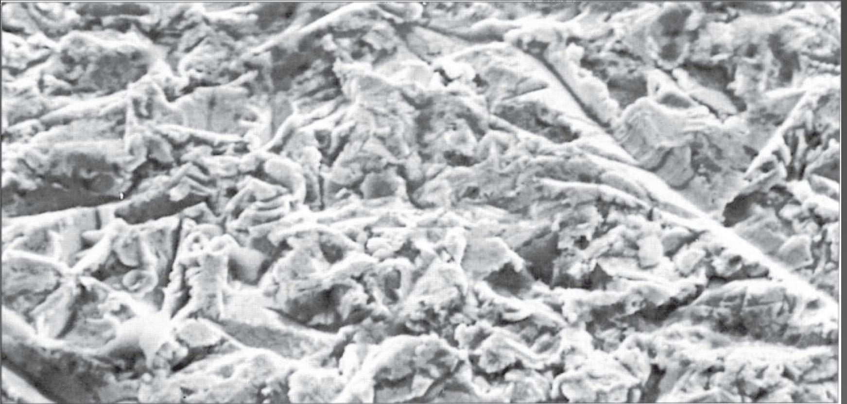
Отображение эвтектической микроструктуры никелево-хромового сплава под сканирующим электронным микроскопом, полученное методом обратного рассеянного отображения
