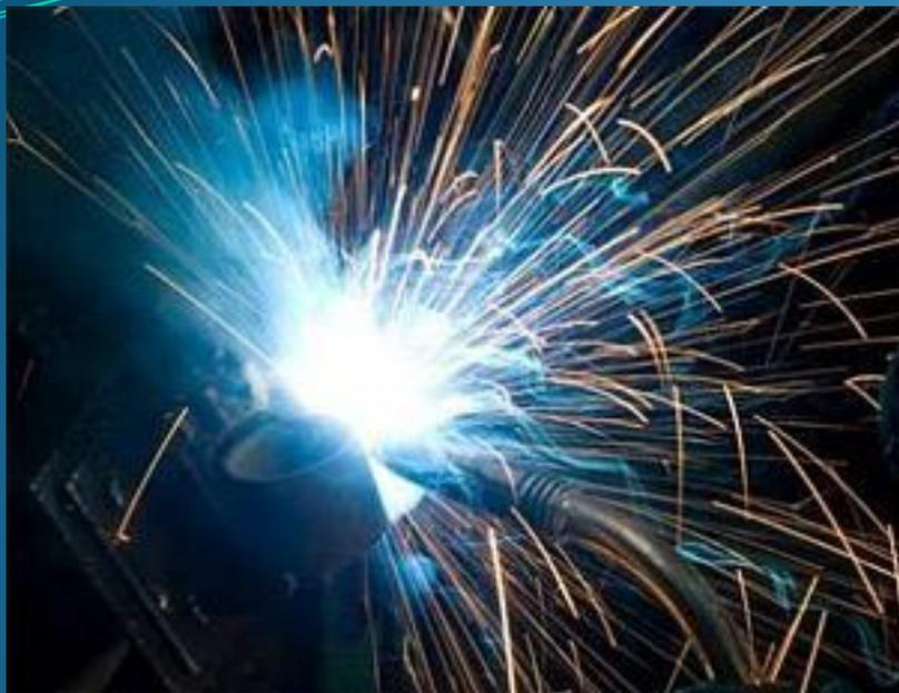
Основные недостатки алюминиевых сплавов — относительно низкая упругость, высокий коэффициент линейного расширения, сравнительная сложность выполнения соединений из-за ограниченной применимости **сварки алюминиевых сплавов**, так как прочность сварных швов, особенно у термически упрочняемых сплавов, ниже прочности основного металла.
