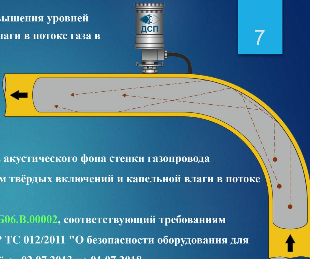
**Принцип действия** основан на выделении из акустического фона стенки газопровода акустического сигнала, обусловленного наличием твёрдых включений и капельной влаги в потоке газа.
