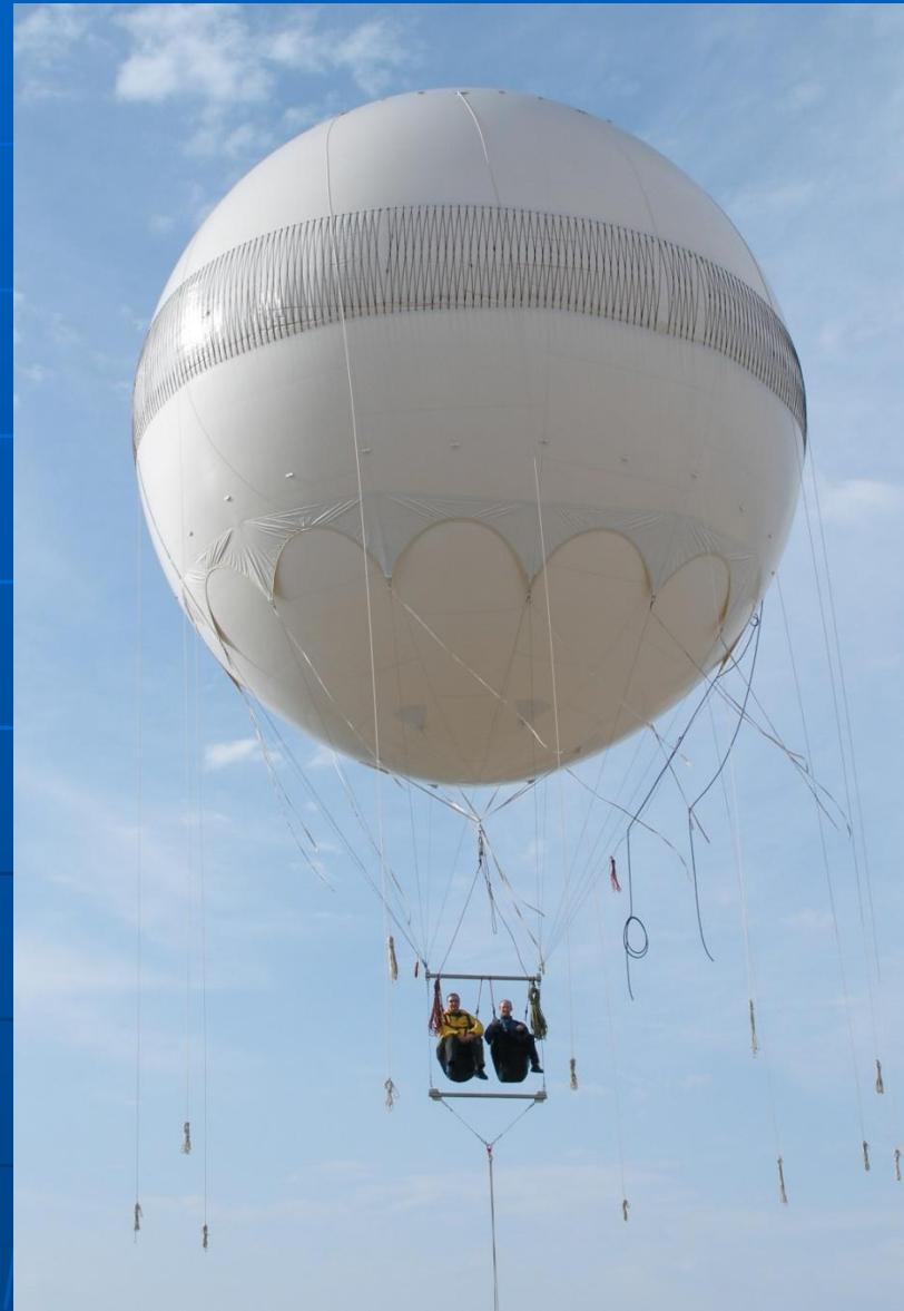
Аттракцион состоит из малообъемного привязаного газового аэростата, 2-местной парапланерной подвески и лебедки, которая установлена на специальной площадке.
