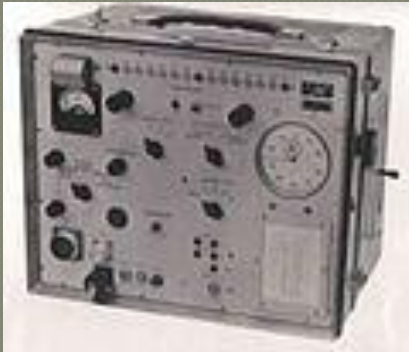
Прибор контроля ответчиков КАСО- МЛ
