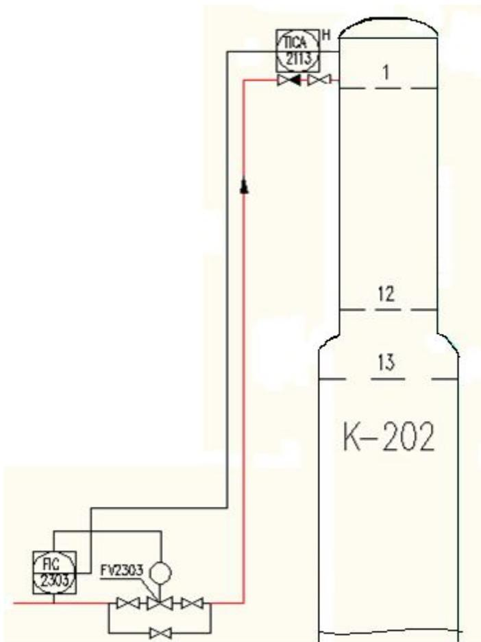
Связь параметров температуры верха колонны и расхода на трубопроводе реализует каскадную АСР
