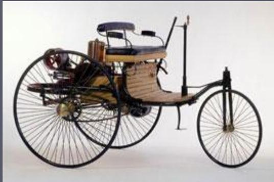
В 1885 году появился первый образец 3-колесного автомобиля с одноцилиндровым двигателем.
