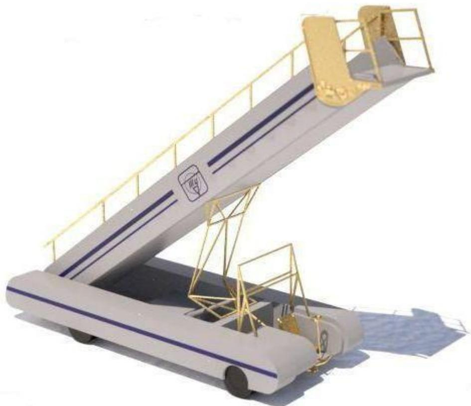
Смонтирован на самоходном шасси, представляющем собой сварную раму, на которой установлены электродвигатель, передний и задний мосты, рулевое управление, аккумуляторная батарея, передние и задние колеса, рессоры, тормозное устройство. Трап оборудован тормозным устройством, зажимающим колодками шкив на электродвигателе. Лестница трапа может быть установлена под различным углом в зависимости от высоты
