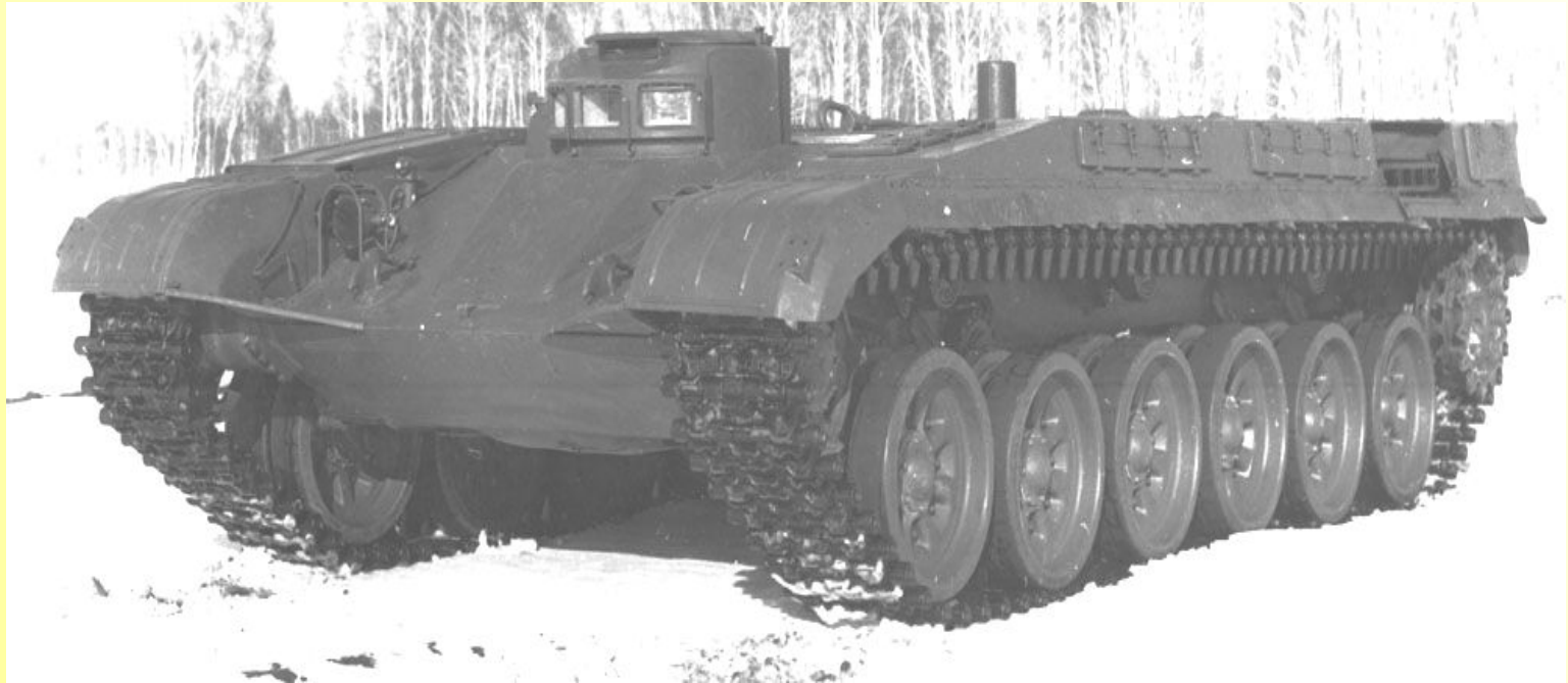
Рис. 3.1. Гусеничное бронированное шасси машины разграждения (общий вид)
