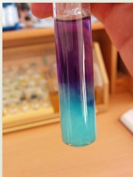
Биуретовая реакция со свежеприготовленным гидроксидом меди (II)
