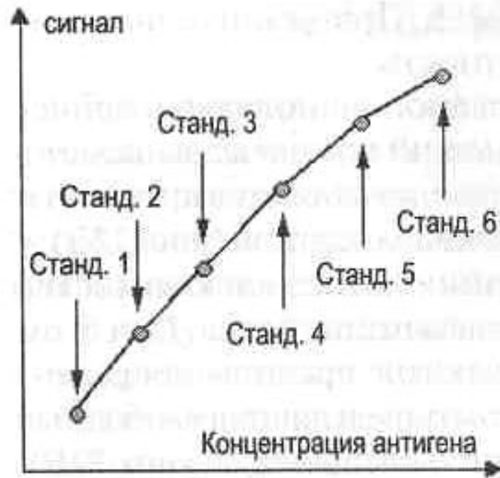
Рис. 74. Калибровочный график, характерный для определения индивидуальных белков турбидиметрическим и нефелометрическим методами. Для построения графика требуется, по крайней мере, 5 стандартных растворов антигена.
