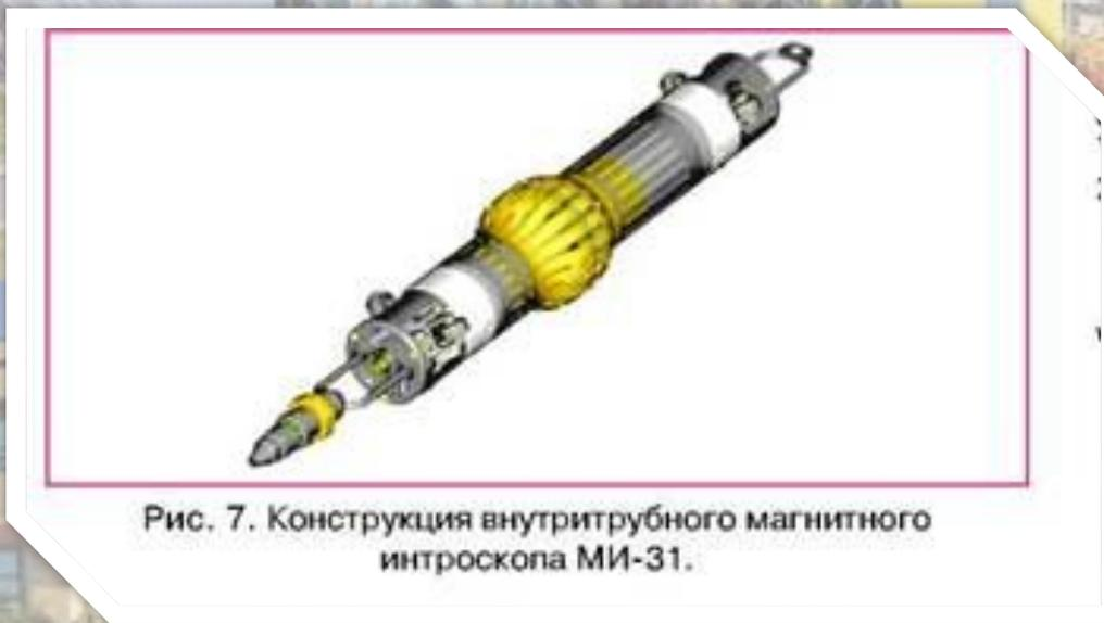
Рис. 7. Конструкция внутритрубного магнитного интроскопа МИ-31.
