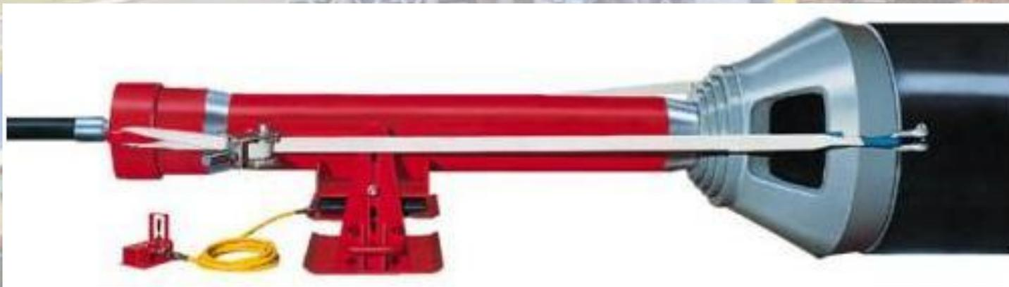
**Машины кладется на лафет и с помощью воздушной подушки точно устанавливается по центру. Корпус машины изготавливается из цельного стального проката, что означает отсутствие слабых мест.**
