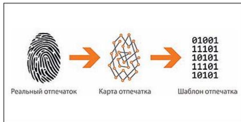
Рис. 2. Алгоритм обработки позволяет хранить не само изображение, а его "образ" (набор характерных данных). Данный принцип верен и для других систем биометрической идентификации
