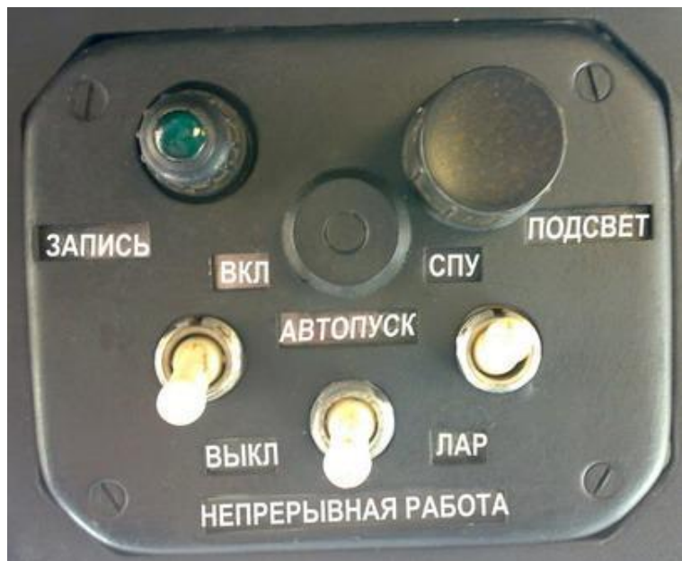
Фото 4 . Пульт управления МС-61Б
