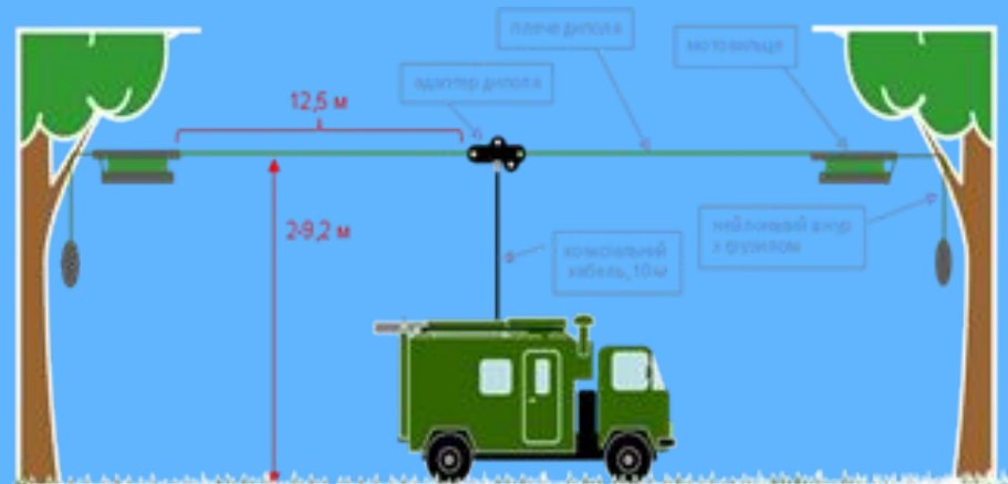
Рис. 5.36. Варіант розгортання антени диполь на базі командно-штабної машини
