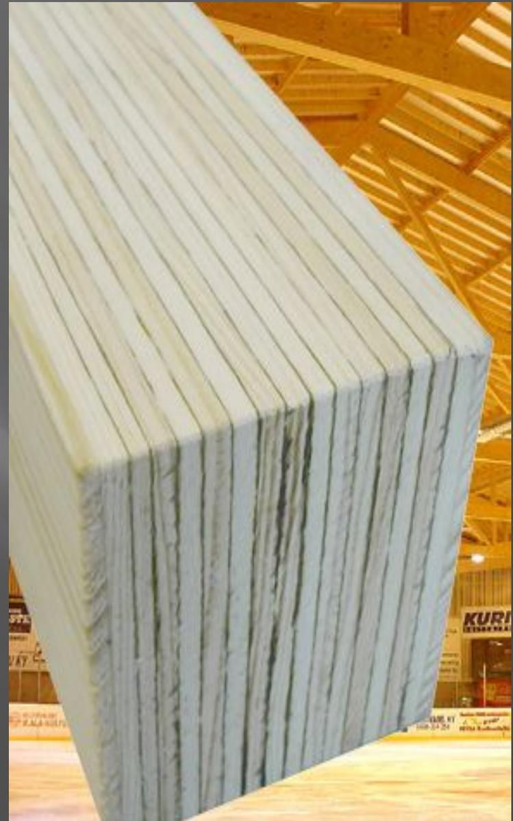
ЛВЛ или LVL (Laminated Veneer Lumber или брус на основе клееного шпона) является высокопрочным конструкционным и отделочным материалом, изготовленным по технологии склейки нескольких слоев шпона с параллельным расположением волокон.
