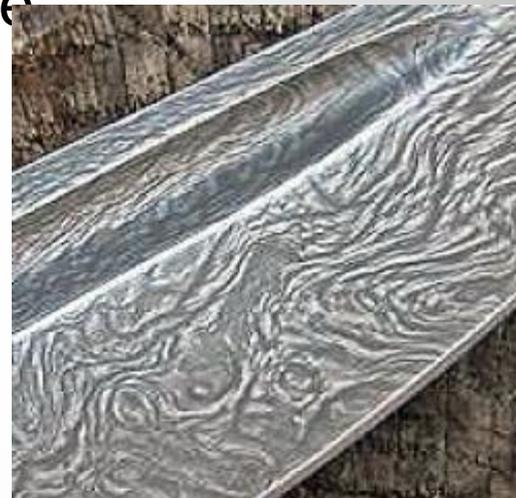
Булатная сталь известна с древнейших времен. Она является более гибкой, чем железо и медь, и обладает большей прочностью, чем бронза. Секрет изготовления булата кроется в уникальном сочетании двух химических элементов — железа и углерода. Как известно, из углерода состоит графит, один из самых мягких минералов. В то же время углерод составляет основу алмаза, самого твердого из минерала. Это свойство углерода и позволяет укрепить крупные частицы железа при плавке.
