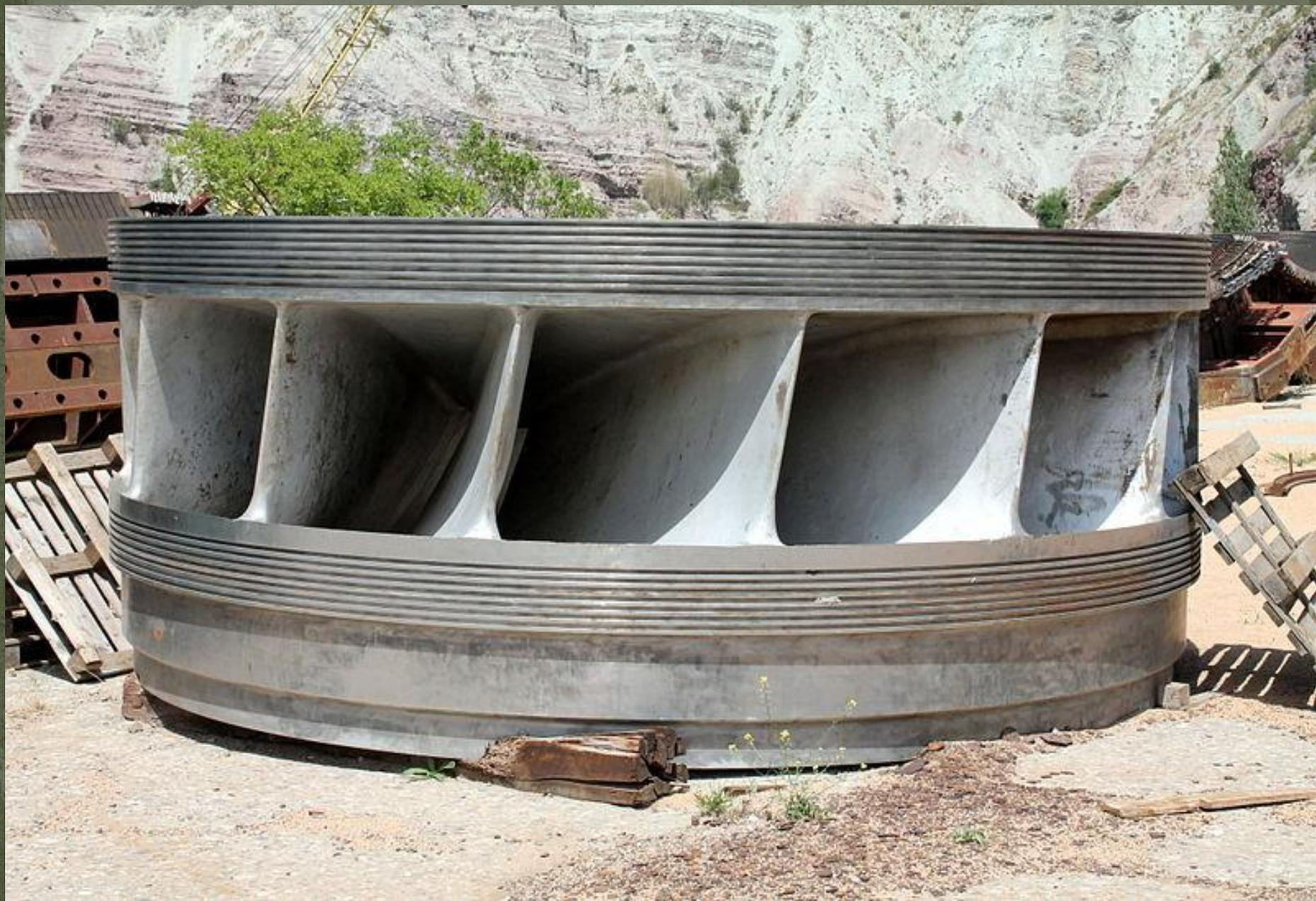
*Рабочее колесо турбины*
