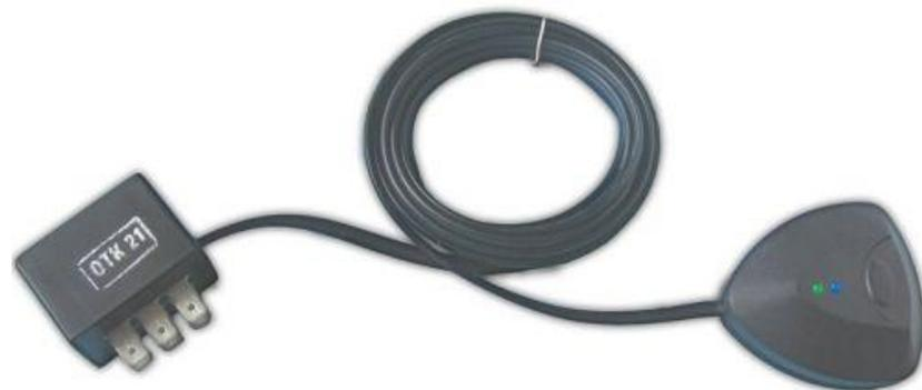
*Это изделие находится на лобовом стекле с внутренней его стороны. От излучающего светодиода инфракрасное излучение попадает на наружную поверхность, отражается от нее и улавливается фотодиодом. Уровень отраженного сигнала зависит от состояния наружной поверхности стекла, от чистого стекла сигнал будет один, от грязного – другой, от мокрого – третий. По величине этого сигнала блок управления определяет необходимость включения дворников.*
