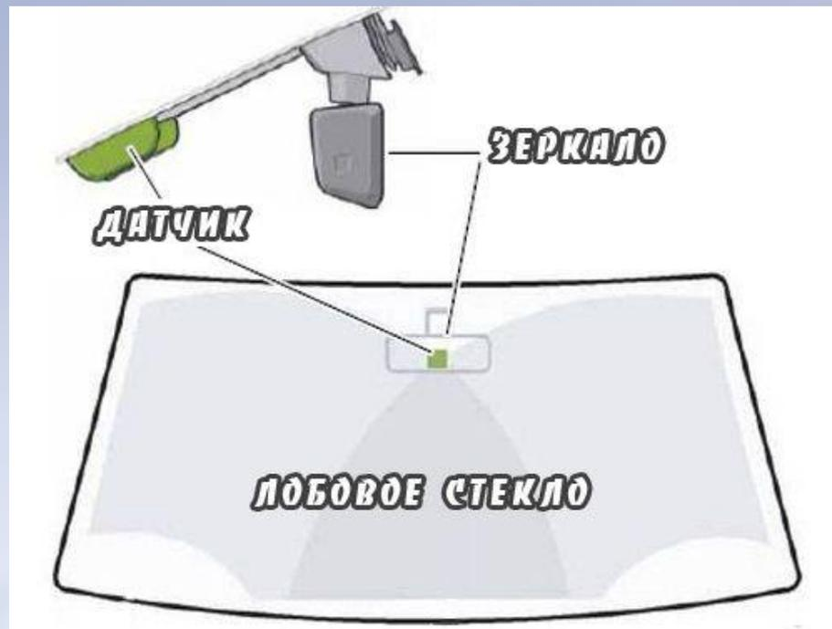
Как видно из рисунка, в отдельном корпусе находится блок управления, связанный жгутом с реле, управляющим работой стеклоочистителя. Блок управления необходимо приклеить в зоне перекрытия щеток дворника, сказанное подтверждает фото лобового стекла с датчиком дождя.
