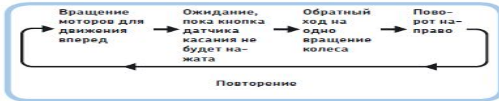
Рис. 6.7. Схема выполнения программы TouchAvoid. После поворота робота направо программа возвращается к началу и повторяется
