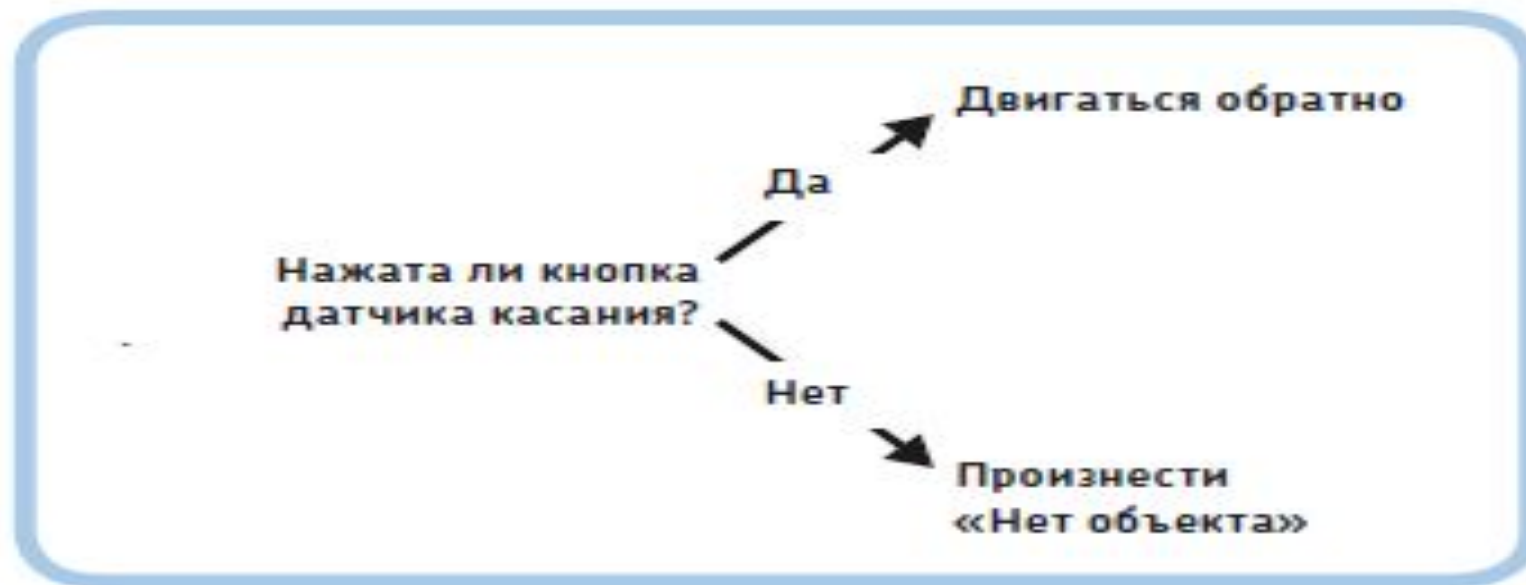
Рис. 6.11. Робот может действовать в зависимости от результата, измеренного датчиком
