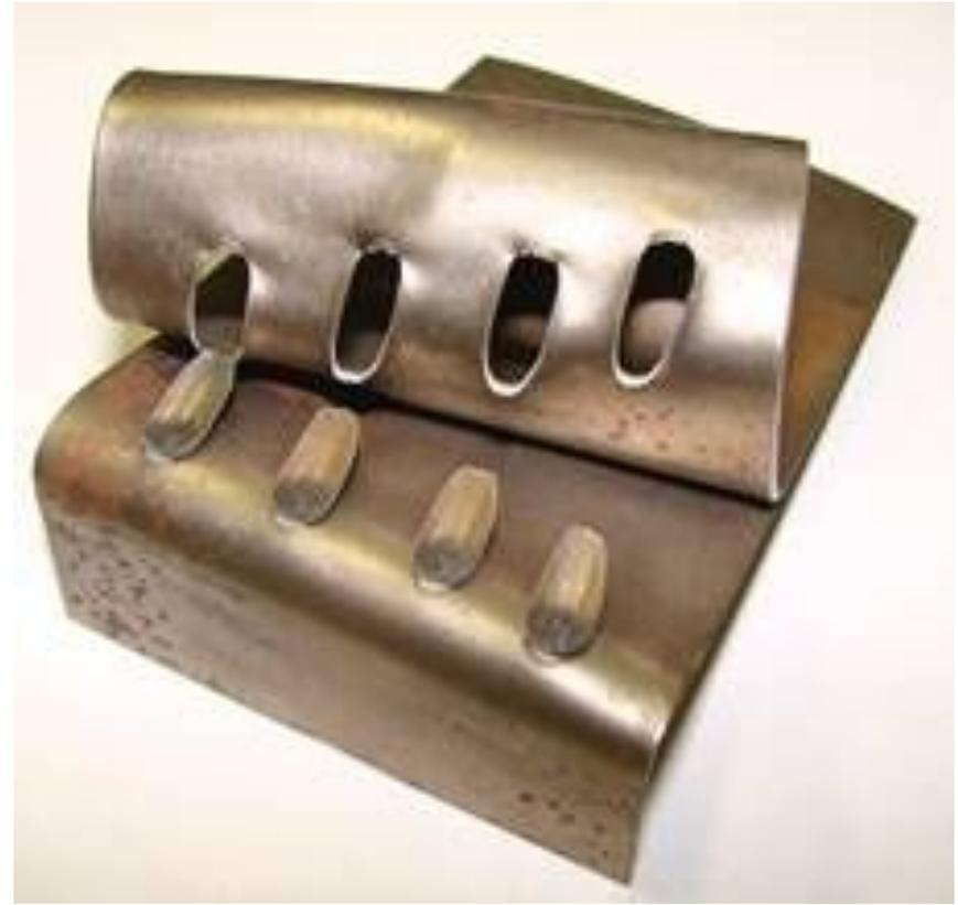
Макрошлифы образцов, заваренным с различным шагом на одном режиме
