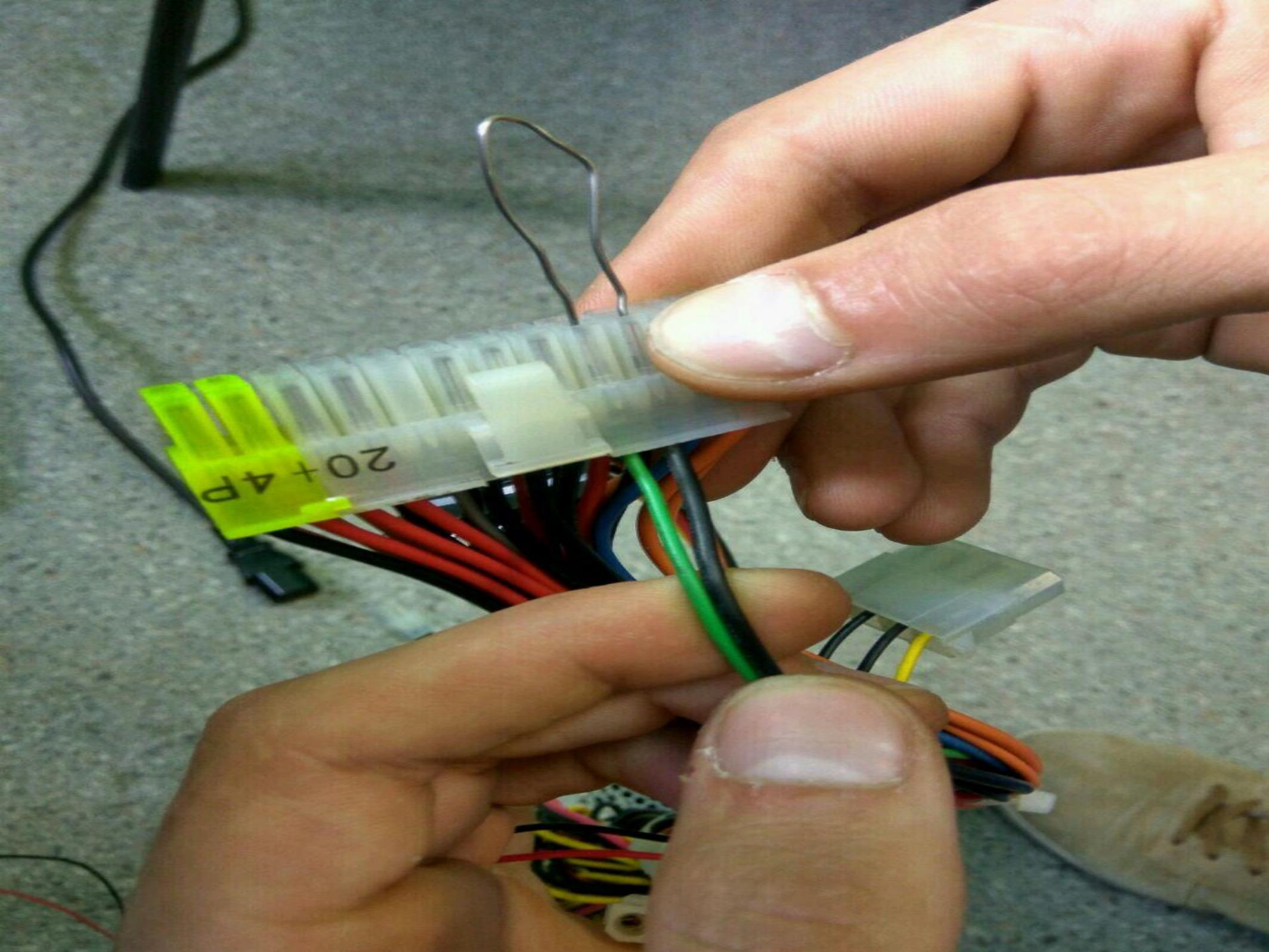
При измерении напряжения существенные отклонения замечены на выходе дежурного питания
