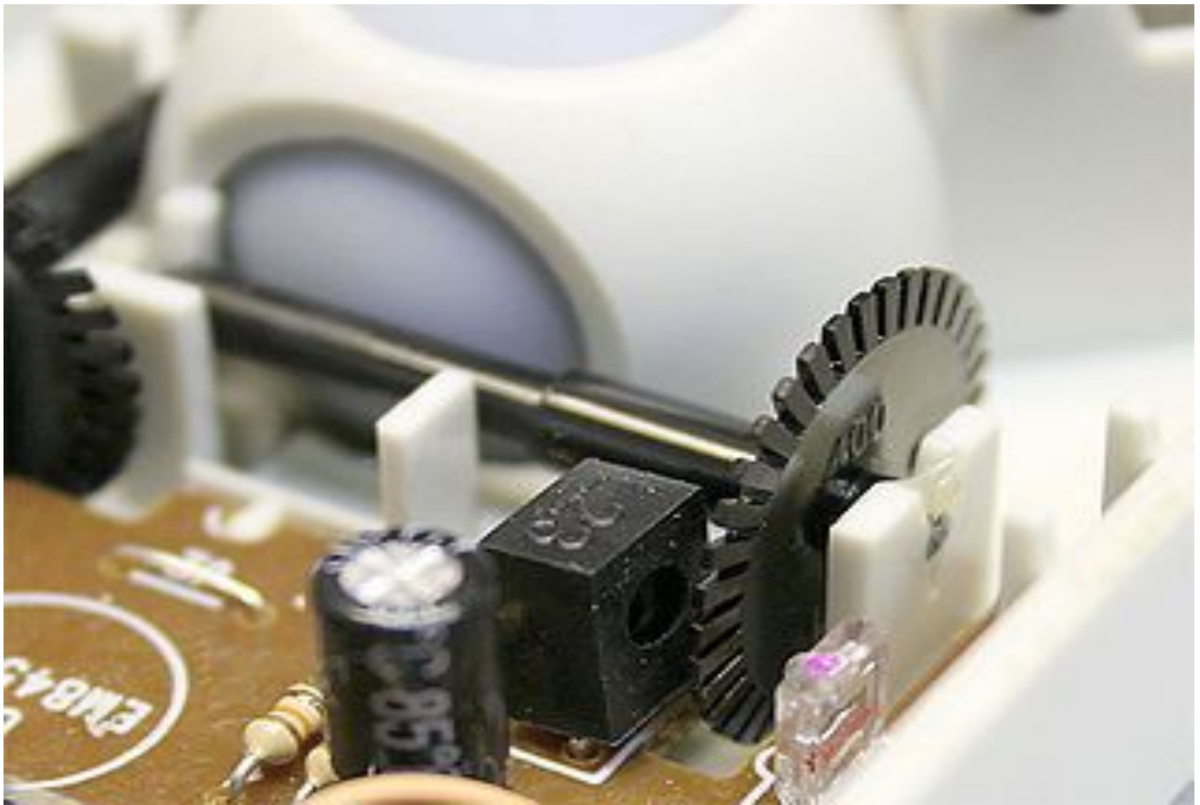
Оптронный координатный счётчик в механической мыши.
