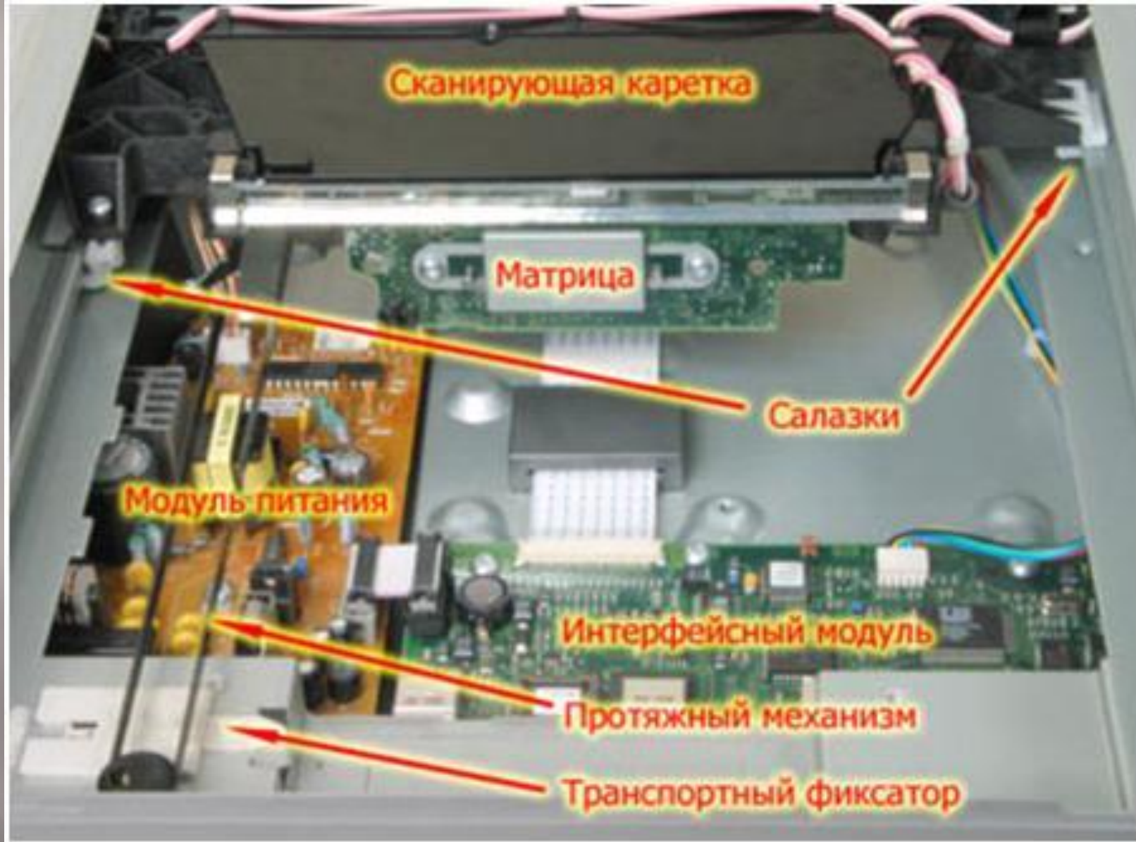
Розташування основних функціональних вузлів сканера
