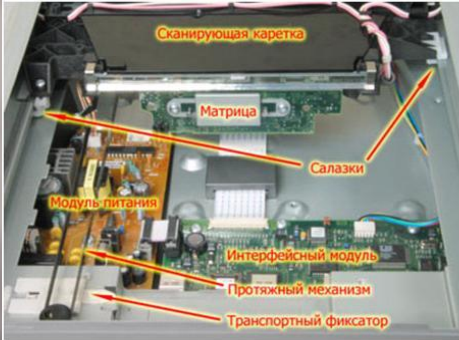
Розташування основних функціональних вузлів сканера
