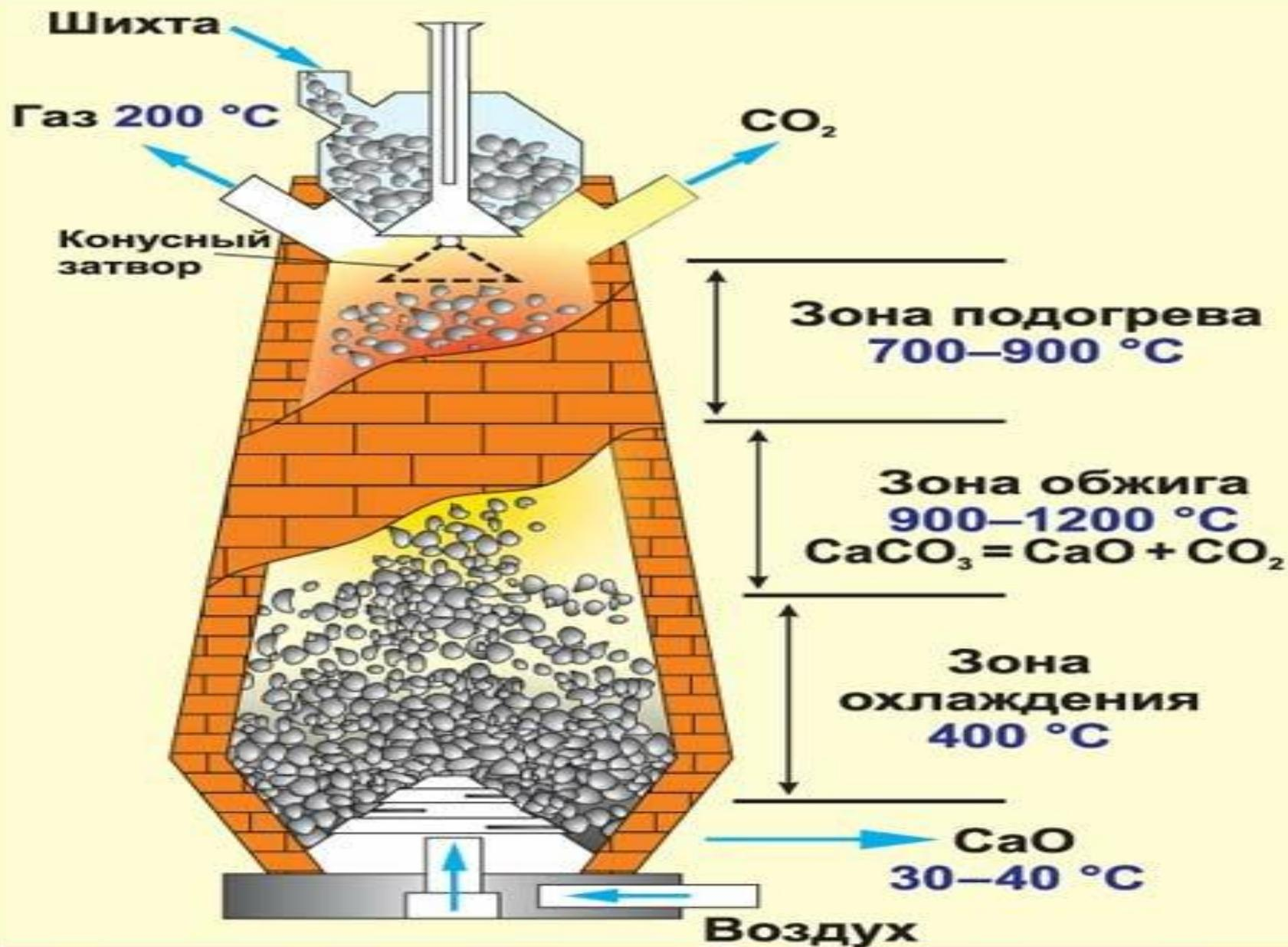
По степени обжига различают извести **мягкообожженные, среднеобожженные и сильнообожженные**. Первые характеризуются отсутствием пережога и быстрой гасимостью. В сильнообожженных известях может присутствовать пережог, для них характерно замедленное гашение,
