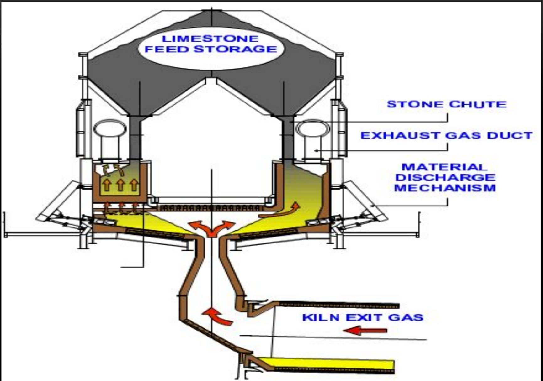
**Обжиг известняка в кипящем слое** по технико-экономическим показателям характеризуется высоким съемом и повышенным расходом топлива — 4600—5480 кДж на 1 кг извести.
