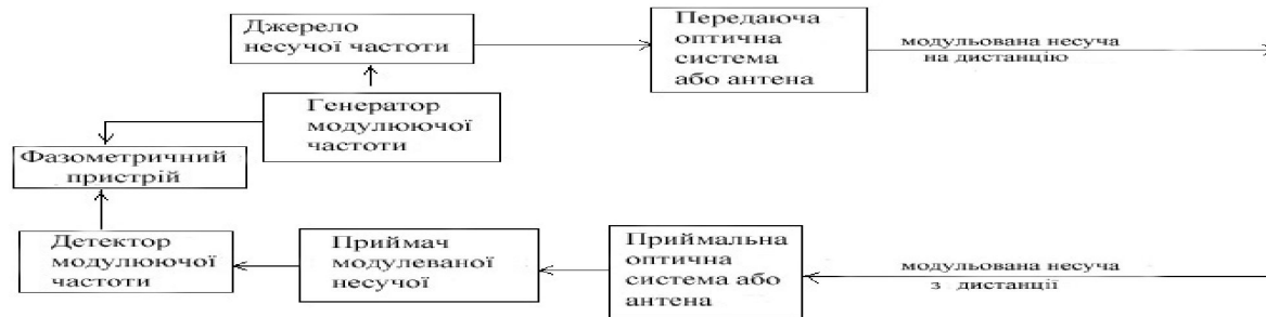
Рис.3.4. Функціональна схема фазового віддалеміра
