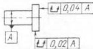
Допуск формы заданного профиля — наибольшее отклонение точек реального профиля от номинального, определяемое по нормали к номинальному профилю
