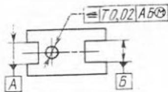
Позиционный допуск — наибольшее расстояние между действительным и номинальным расположением. Если заданы базы, то номинальное расположение определяют относительно баз
