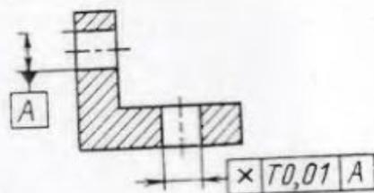
Пример нанесения допуска на чертеже по ГОСТ 2.308-79
