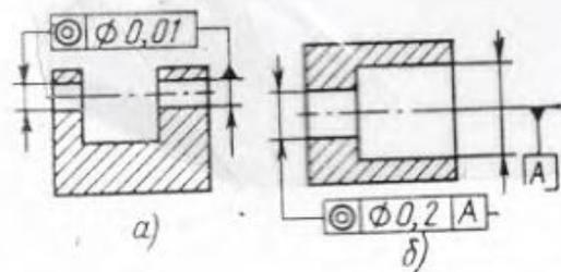
Допуск симметричности — наибольшее расстояние между плоскостью или осью симметрии рассматриваемой поверхности и плоскостью или осью симметрии базовой поверхности
