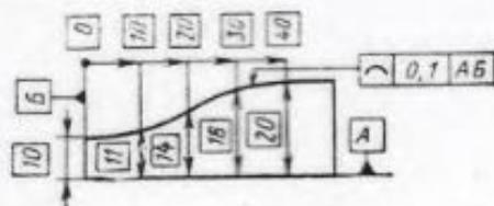
Допуск формы заданной поверхности — наибольшее отклонение точек реальной поверхности от номинальной поверхности, определяемое по нормали к номинальной поверхности
