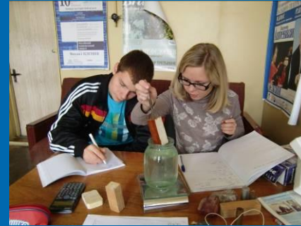
Гидростатическое взвешивание тел.
