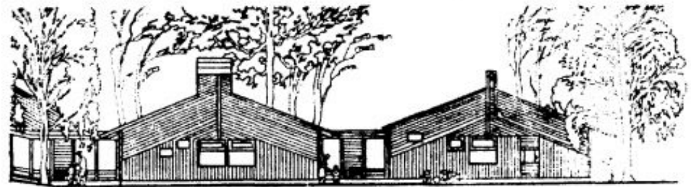
Рис. 44. Косая, вертикальная и горизонтальная обшивки на фасадах зданий детского сада в Сандвикене, Швеция (по Л. Лисенко)
