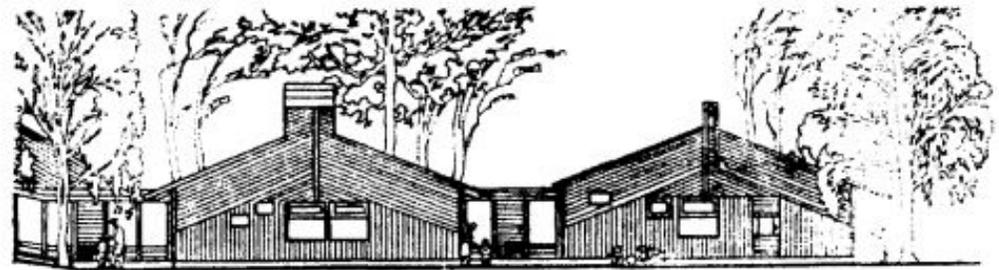
*Рис. 44. Косая, вертикальная и горизонтальная обшивки на фасадах зданий
