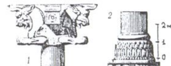
Рис. 11. Детали персидской архитектуры: 1 — капитель, 2 — база колонны.
