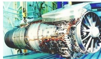
ТРДД НК-93 (1989г.) Первый в мире ТРДД со сверхвысокой степенью двухконтурности (m=16,6)
