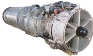
ТРДДФ Р79В-300 (1977г.) Первый в мире подъемно-маршевый двигатель с форсажем
