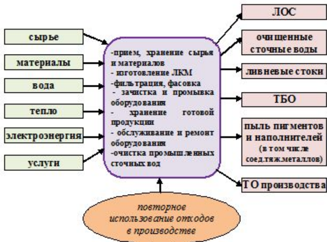
Схема функционирования предприятия по производству органических ЛКМ
